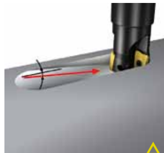
Penetración en rampa, estrategia de fresado en espiral
