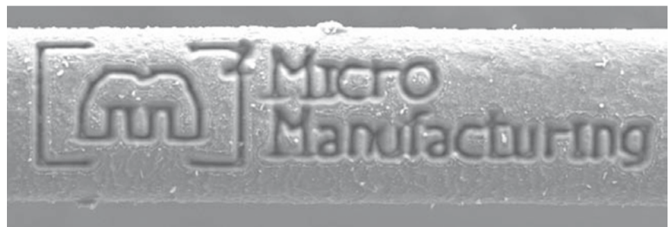
Menschliches Haar mit Laser-Mikrobearbeitung
