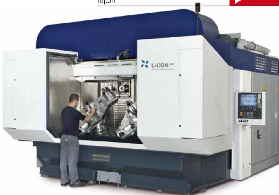
*LiFLEX II 1066 ist der größte unter den horizontalen Doppelspindlern im Licon Maschinenprogramm. Werkstücke bis zu einer Größe von 1.000 mm können auf dieser Maschine in einer Aufspannung bearbeitet werden.*
