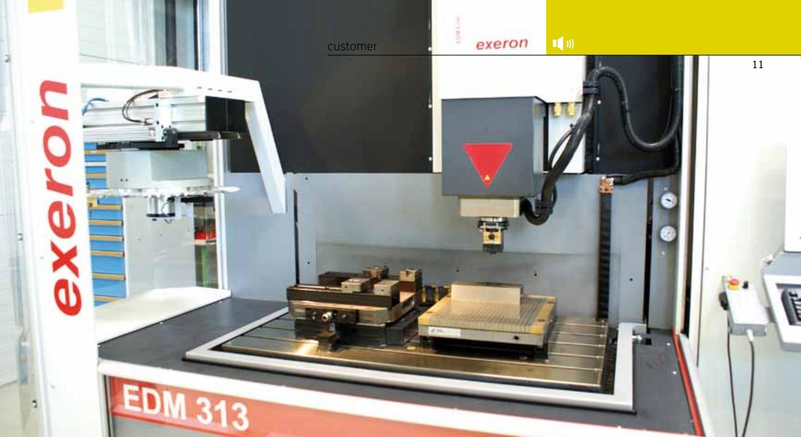
Die Erodiermaschinen der EDM-Baureihe sind mit Wegmesssystemen von Fagor und der hauseigenen exeron-Steuerung ausgestattet. Die EDM 313 ist eine von sechs verfügbaren Varianten dieser Baureihe.
