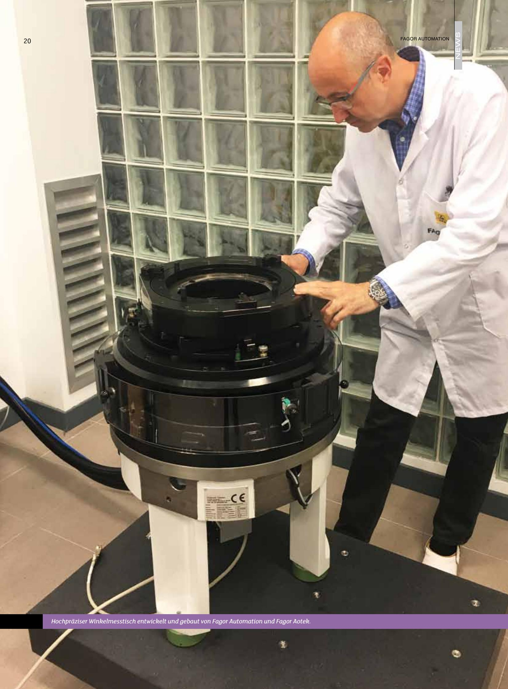
Hochpräziser Winkelmesstisch entwickelt und gebaut von Fagor Automation und Fagor Aotek.
