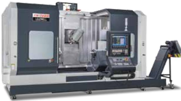
La macchina multifunzione Leadwell è in grado di fresare, tornire, svolgere entrambe le operazioni simultaneamente, forare e copiare superfici. È l'ideale sia per aziende di produzione, sia per la fresatura di superfici curve tipiche nell'industria aeronautica.
