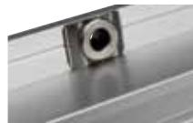
Dieses Befestigungssystem reduziert Messfehler, die aufgrund von thermalen Veränderungen an der Maschine auftreten können.
