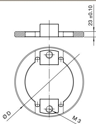
Dibujos representativos del encoder angular de eje hueco y diámetro 90 mm (H3-D90).
