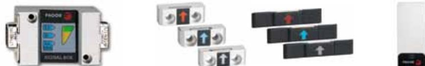
La gamme des codeurs linéaires sans contact est pourvue de nombreux accessoires. Actionneurs magnétiques utilisés pour la limitation de course et la sélection de la marque de référence. L'alignement de la tête de lecture est facilité par l'utilisation d'un séparateur plastique transparent et d'un appareil testant l'intensité du signal.
