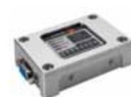
Le dispositif d'évaluation de signal et de protocole (PSED) est un outil de test conçu et fabriqué par Fagor pour le diagnostic, l'aide à l'installation et le service après-vente des codeurs linéaires et angulaires.
