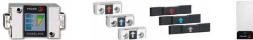
L'encoder lineare senza contatto si fornisce con diversi accessori che lo completano. Si utilizzano degli attuatori magnetici per attivare i micro di fine corsa e per selezionare la marca di riferimento. Per aiutare nel montaggio della riga si possono utilizzare gli spessori trasparenti in dotazione e il dispositivo opzionale per misurare la intensità del segnale.
