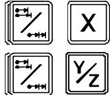
Bei Modell 20iE, es ist möglich, daß beim Installationsparameter PAR11(1) den Wert "0" eingegeben wurde, damit die Taste auf jede Achse unabhängig einwirkt. So kann die Position der einen Achse inkremental und die der anderen absolut angegeben werden. In diesem Fall muss man, um den Anzeigemodus für eine bestimmte Achse zu ändern, eine der beiden Tastenkombinationen drücken.
