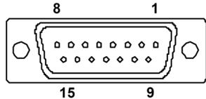
X4 ist ein Stecker SUB-D weiblich mit 15 Steckplätzen, um 4 optisch gekoppelte Digitaleingänge und 6 optisch gekoppelte Digitalausgänge mit Festkörper-Relais, mit normalerweise offenem Kontakt anzuschließen, die zur Aktivierung von Relais, Signalisierung, usw. verwendet werden können.
