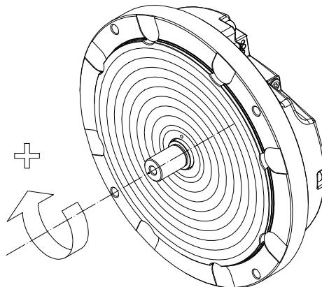
Zur Montage des Wegmesssystems auf der 0\u00b0-Position, die Welle drehen und die Marken von Welle und Geh\u00e4use aneinander ausrichten.
