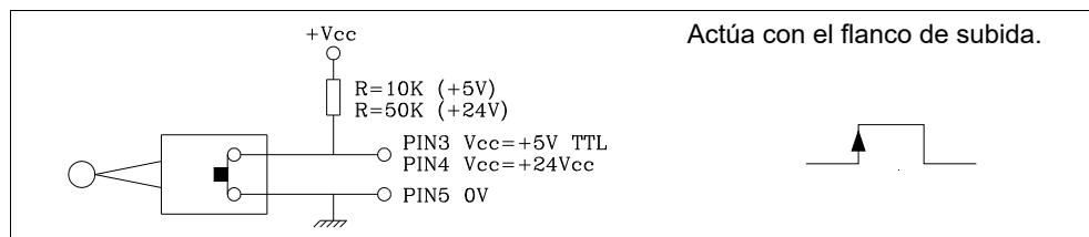
Interface con salida en colector abierto. Conexión a +5 V.
