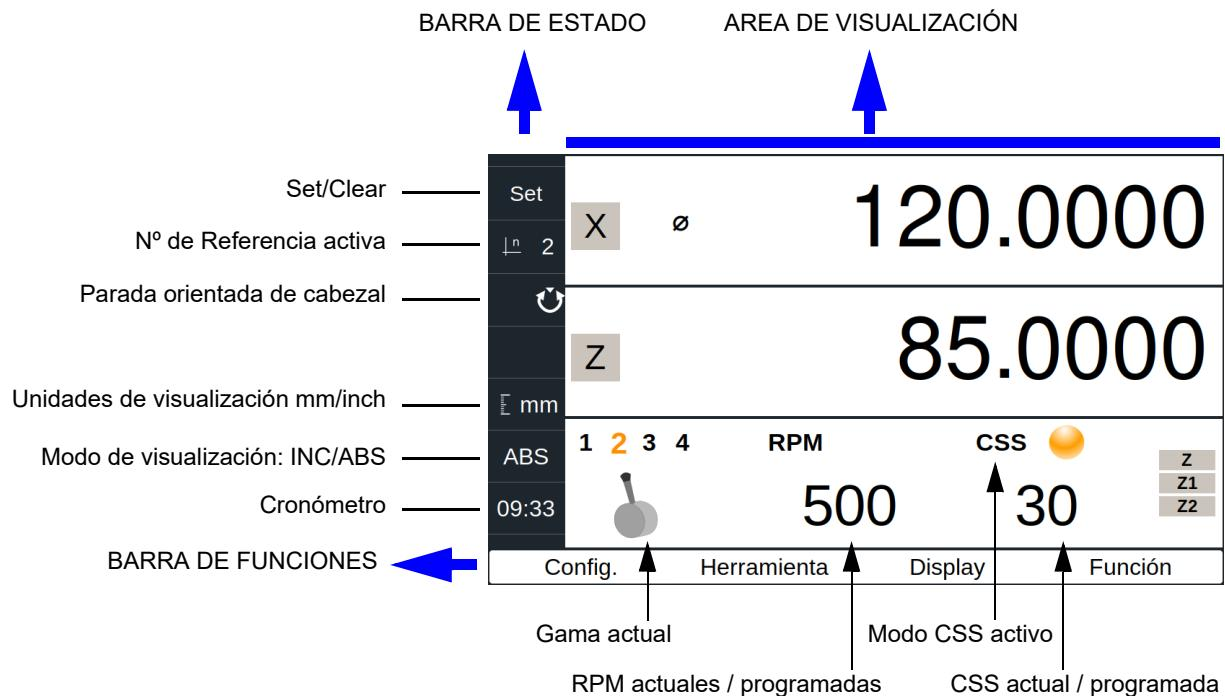
Cuando el cabezal está apagado, los displays de RPM y VCC (CSS) muestran los valores programados.
