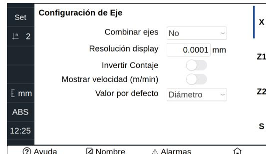
Valor de fábrica: 0,0000. Significa que la resolución display (resolución de visualización) es la resolución del encóder.
