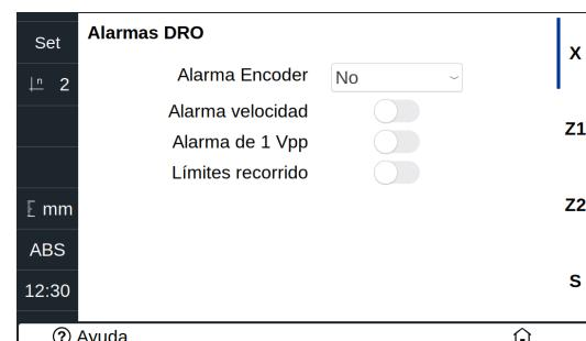
**1- Alarma 1 Vpp:** El visualizador controla la amplitud y desfase de las señales de 1 Vpp. Si alguna de las señales saliera de los límites establecidos, se visualiza una alarma.
