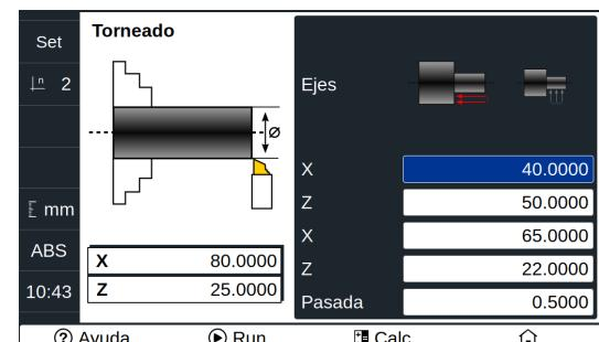
**Cortar:** Introducir espesor de pasada en mm. El visualizador utilizará este valor también como distancia de seguridad a retroceder en cada pasada.
