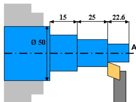
Preseleccionar “**25**” en el eje Z. Realizar varias pasadas llevando el eje Z a cero hasta reducirlo al diámetro deseado.
