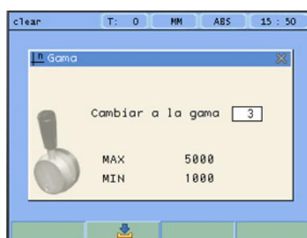
Si se detecta que la Gama ha cambiado durante el mecanizado, el cabezal se parará inmediatamente y no se podrá poner en marcha hasta confirmar el cambio de gama en el DRO.
