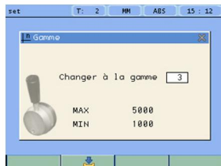
Si le système détecte que la gamme a changé pendant l'usinage, la broche s'arrête immédiatement et ne pourra être remise en marche qu'une fois le levier soit placé sur la position correcte indiquée par le Compteur Numérique.
