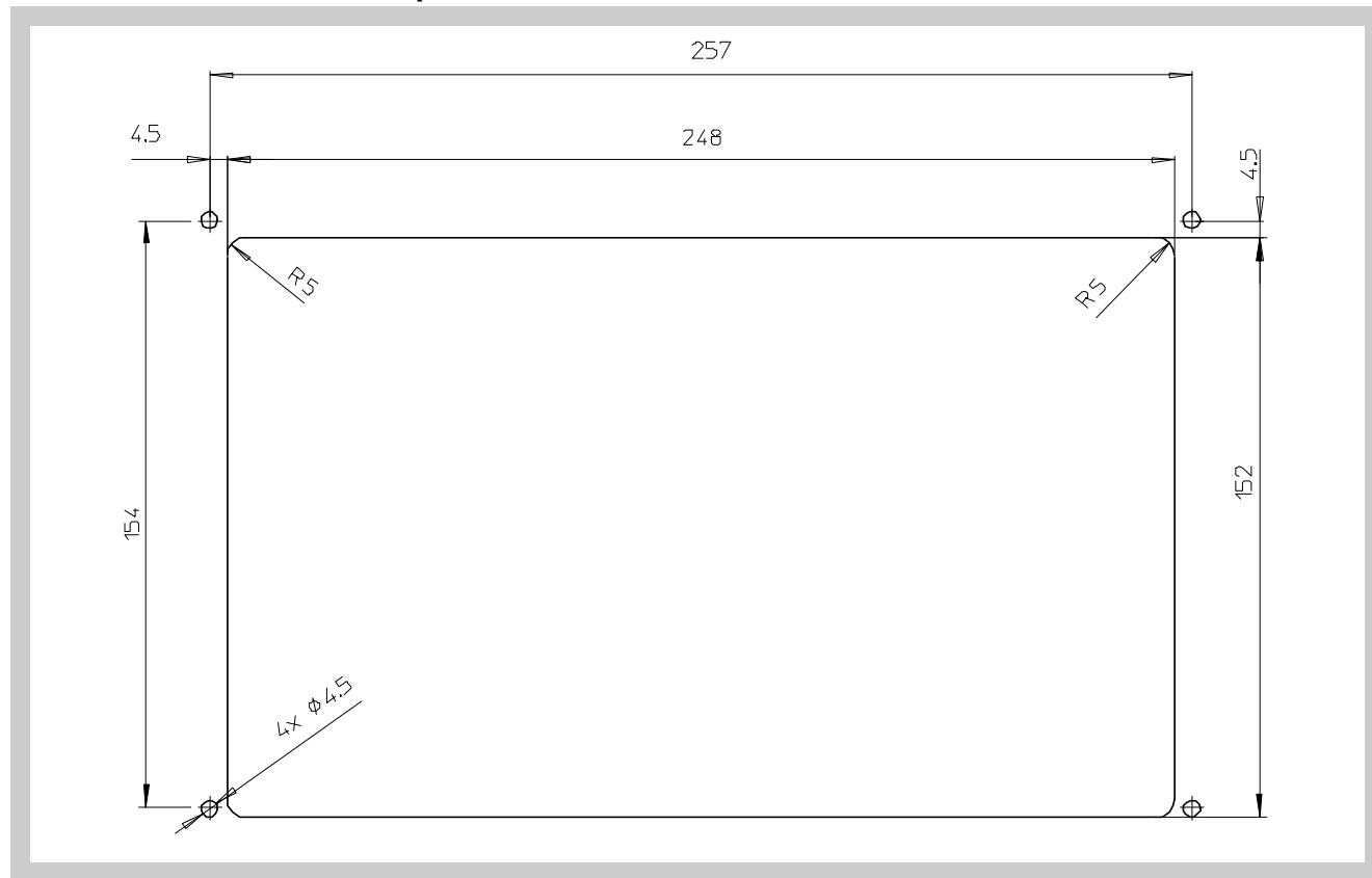
Montaggio del visualizzatore ad incastro
