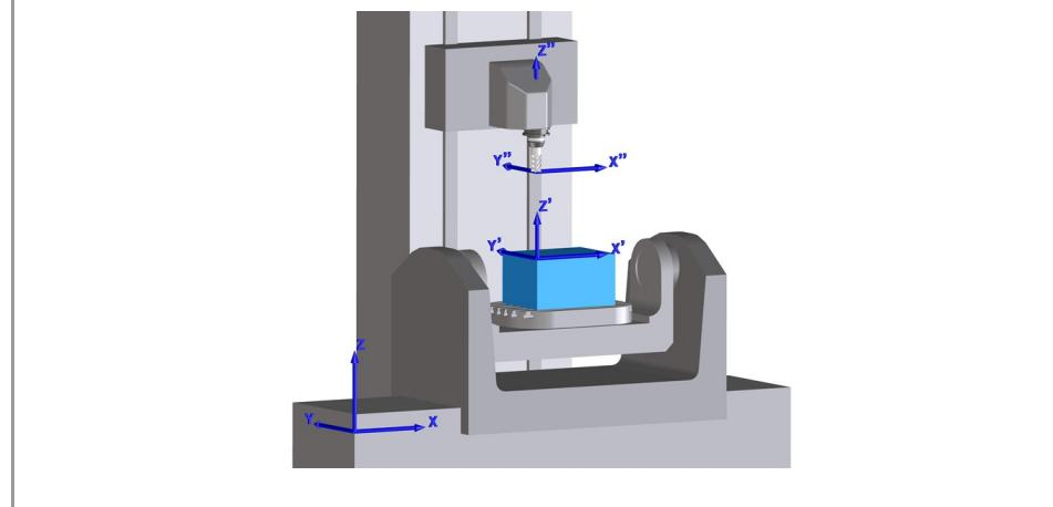
O movimento da mesa sem o RTCP ativo não altera a orientação do sistema de coordenadas da peça (X' Y' Z').
