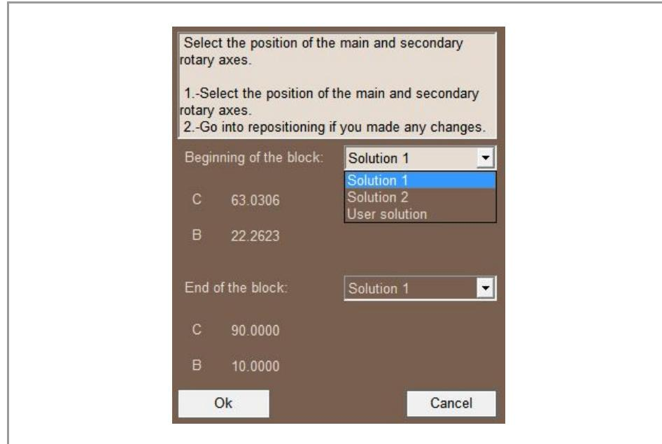
Por padrão, o CNC oferece uma solução. Se o usuário seleciona a solução oferecida pelo CNC, este continua com a execução. Se for selecionada uma solução diferente da oferecida pelo CNC, este acessa a inspeção de ferramenta para reposicionar os eixos. Uma vez dentro da inspeção de ferramenta, o processo será o seguinte.
