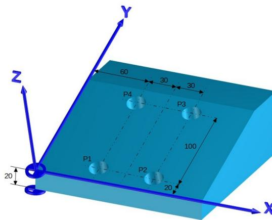
**FERRAMENTA PERPENDICULAR AO PLANO INCLINADO**
