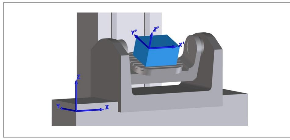
A ativação de um plano inclinado (#ACS/#CS) altera o sistema de coordenadas da peça (X' Y' Z').
