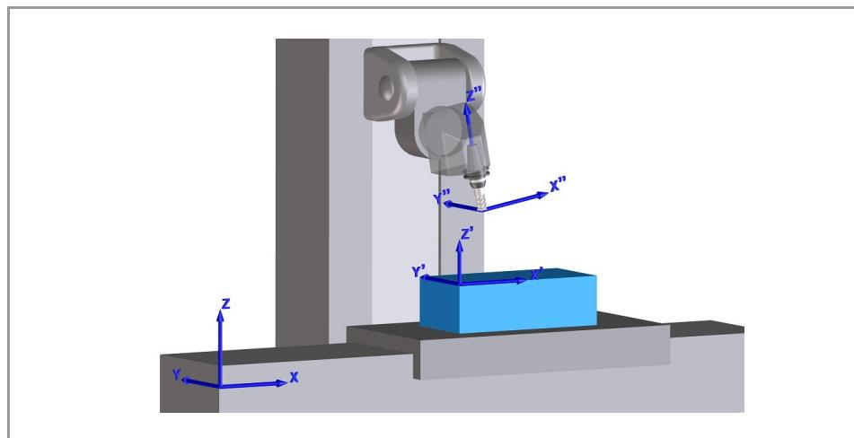
A ativação de um plano inclinado (#ACS/#CS) altera o sistema de coordenadas da peça (X' Y' Z').
