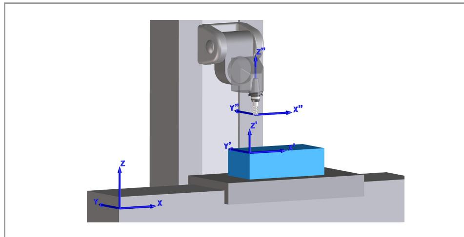
O movimento do spindle altera a orientação do sistema de coordenadas da ferramenta (X" Y" Z").
