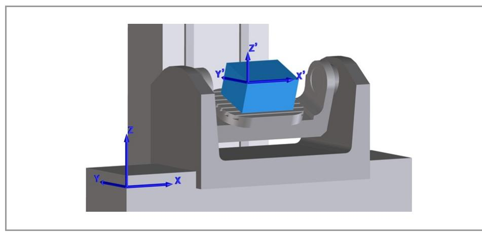
O movimento da mesa com o RTCP ativo altera a orientação do sistema de coordenadas da peça (X' Y' Z').
