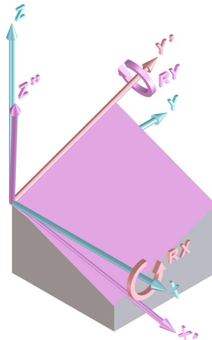
Plano gerado com duas rotações: primeiro sobre o eixo X e depois sobre o novo eixo Y.
